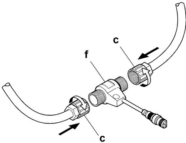
**6.5** Die Überwurfmutter (c) auf den Elektro-T-Verteiler (f) aufsetzen und mit dem erforderlichen Drehmoment (1,2 Nm) anziehen.
