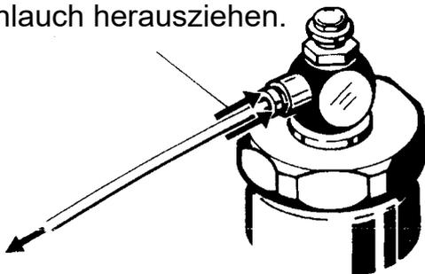
Kunststoffschlauch in Druckring einschieben, bis Widerstand spürbar ist.
