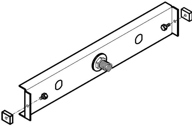
4.2 Gewindeplatten mit Sechskantschrauben SW 8 an der Befestigungstraverse montieren
