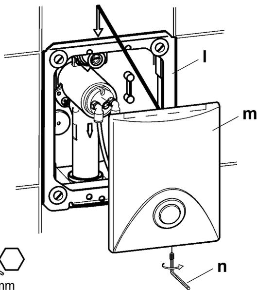
6.11 Die Abdeckplatte (m) auf den Halterahmen (l) einhängen.
