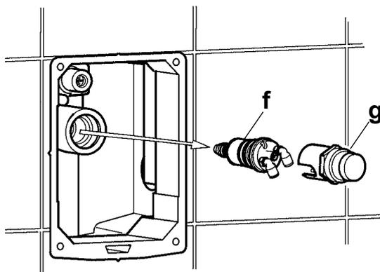
6.6 Das Selbstschluss-Kartuschelement (f) mit dem Montageschlüssel (g) herausdrehen.
