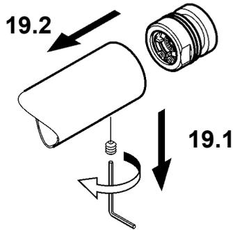
**19.1** Den Gewindestift im Auslauf mit einem Innensechskant-Schlüssel lösen.
