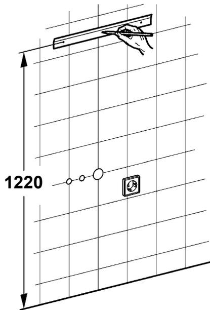
**10.1** Die Bohrungen für die Einhängeleiste entsprechend den Maßen anzeichnen.
