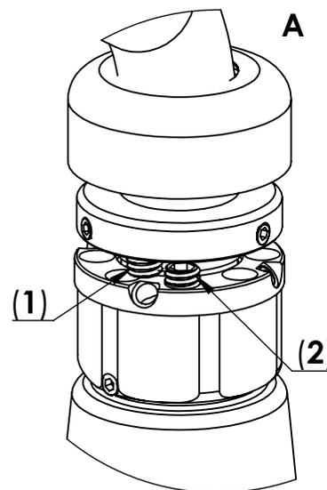
Neue Befestigungsmutter aufschrauben mit Gewindestift M5 sichern
